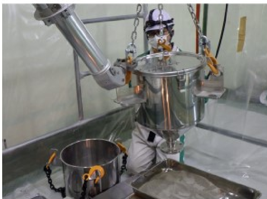
Photo 3.3.3.2 せん断粉末装荷用のホッパ及び収納容器の適用性確認（MP G346）
