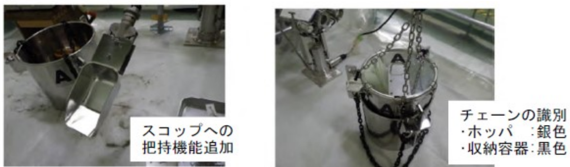
Photo 3.3.3.1 モックアップ訓練を踏まえて改良した治具類
