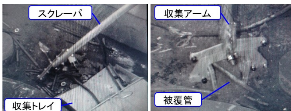
Photo 2.2.4.1 治具類によるセル床面からの被覆管等の収集
