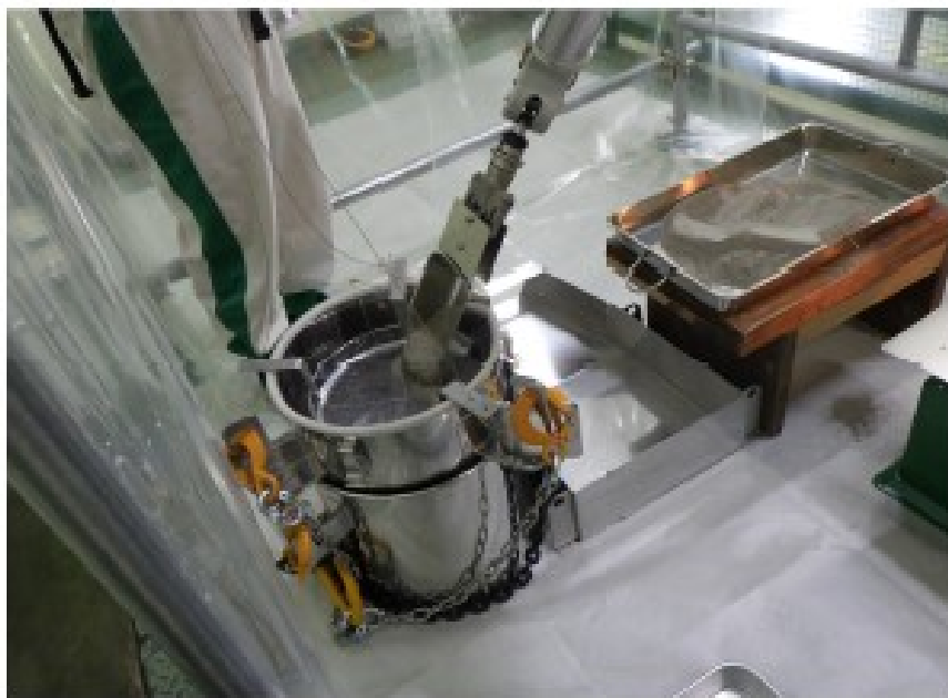
Photo 3.3.3.3 模擬せん断粉末（砂、セメント粉及び鉛毛）による トレイからホッパへの移し替え訓練（MP G346）
