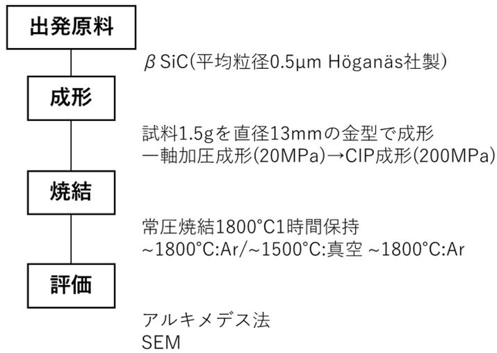
図 3-1 焼結体の作製及び評価手順
