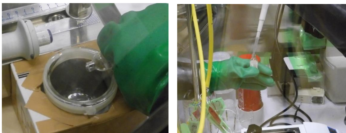
Fig. 5 ^{90}\text{Sr} 及び ^{137}\text{Cs} 含有水溶液の pH 調整 (3)作業写真
