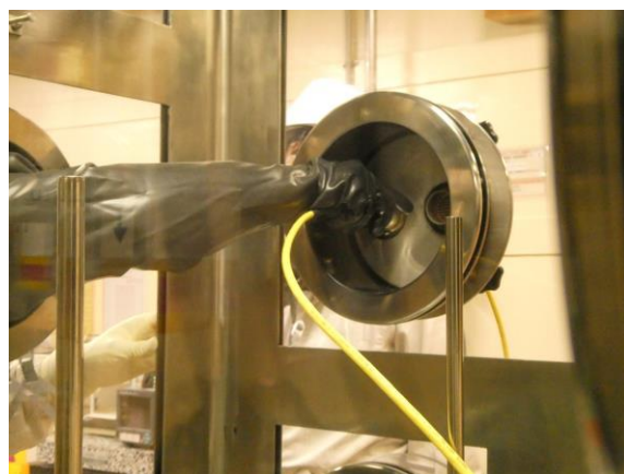
気密コネクタのボックス内部接続作業
