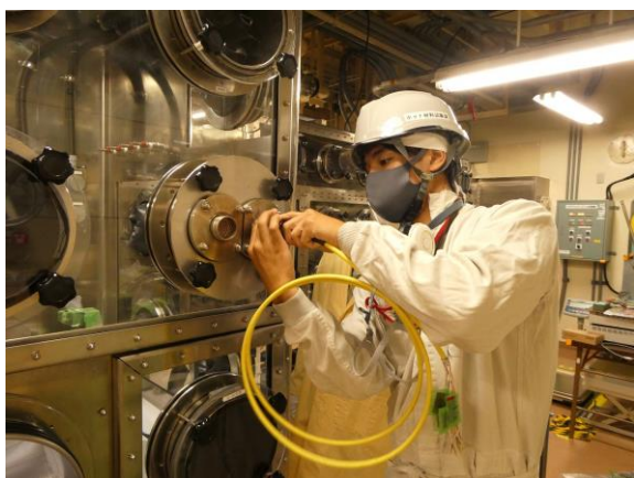
気密コネクタのボックス外部接続作業
