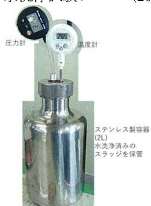
Photo 5.1 安定性確認に使用したステンレス容器外観図
