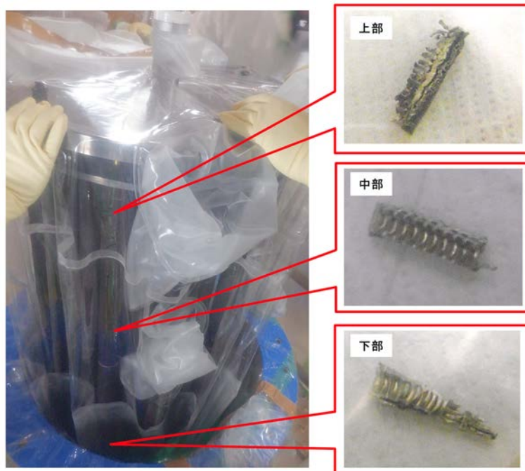
図 2.4 フィルタエレメント⑤から採取した SEM 観察用試料
