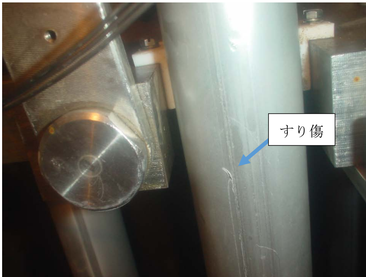
Fig. 1.3.12 C5 連結ロッドのすり傷
