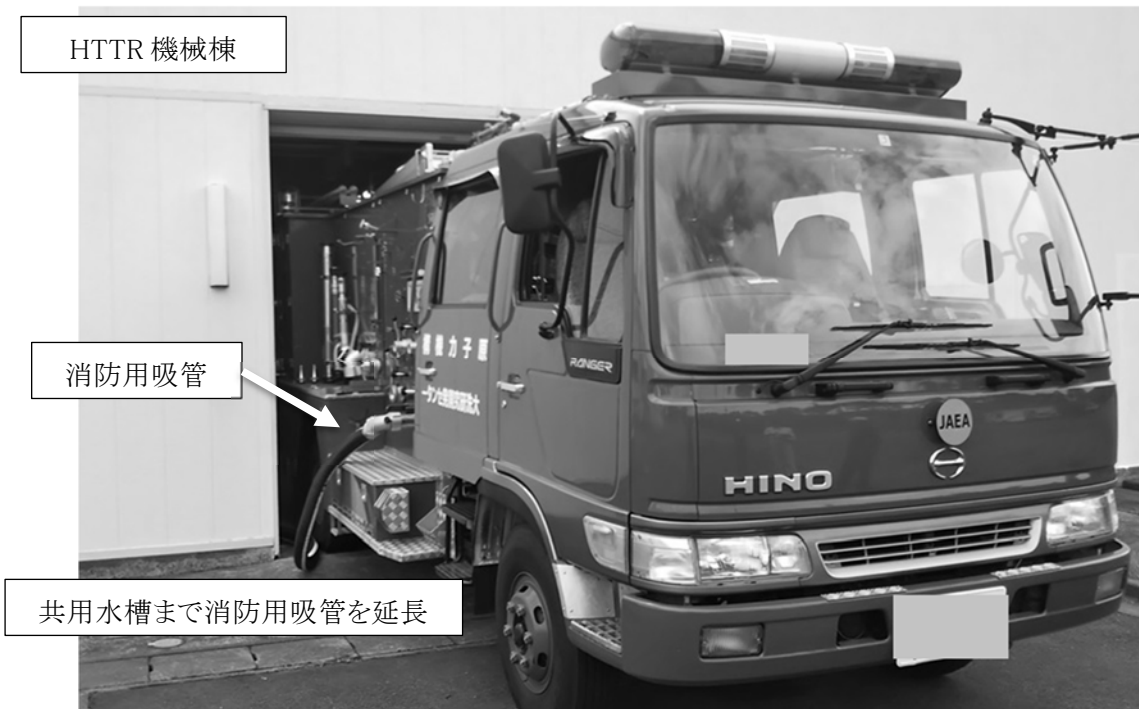
(a) 車両の停車位置及び消防用吸管の敷設
