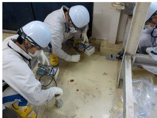
簡易ハウス設置前汚染検査
