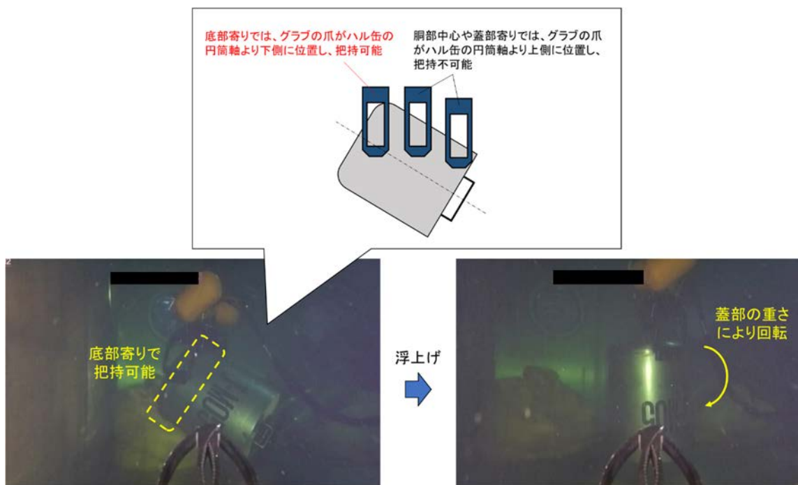
図 42 斜め下向きハル缶への水中リフタ（グラブ式）の取付け（移動式カメラの映像）
