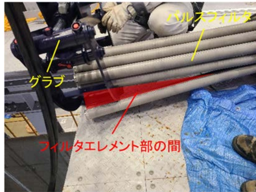
図 35 パルスフィルタへのグラブの爪先の噛みこみ
