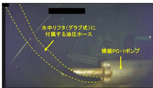
図 44 ケーブル類が他の廃棄物に引っ掛かる事象（移動式カメラの映像）
