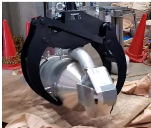
図 33 フィルタ類、汚染機器類を抱え込んで把持した際の様子
