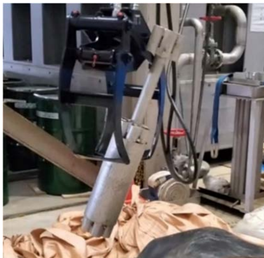
図 34 フィルタ類、汚染機器類を掴んで把持した際の様子
