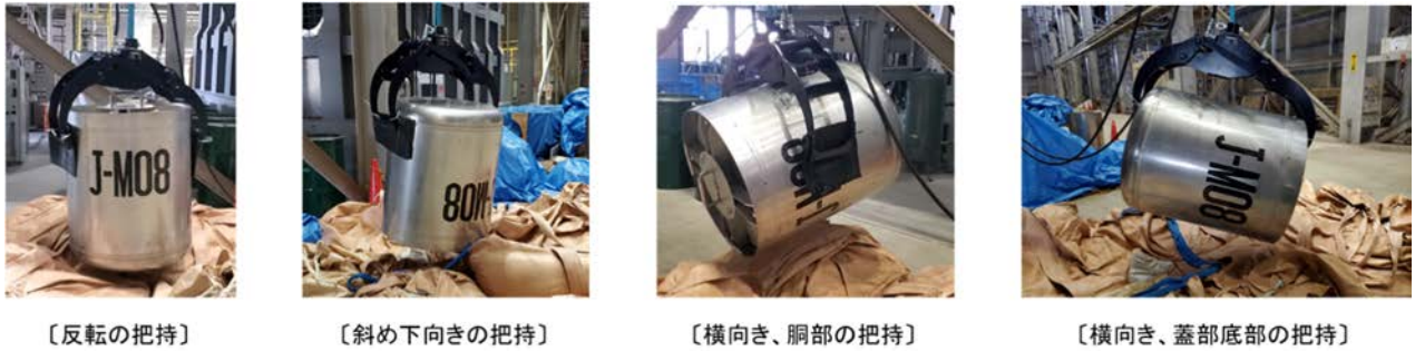
図 32 ハル缶を把持して持ち上げた際の様子
