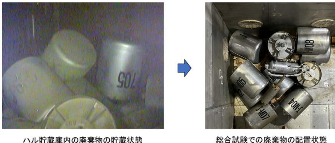
図 47 総合試験時の廃棄物の配置状況
