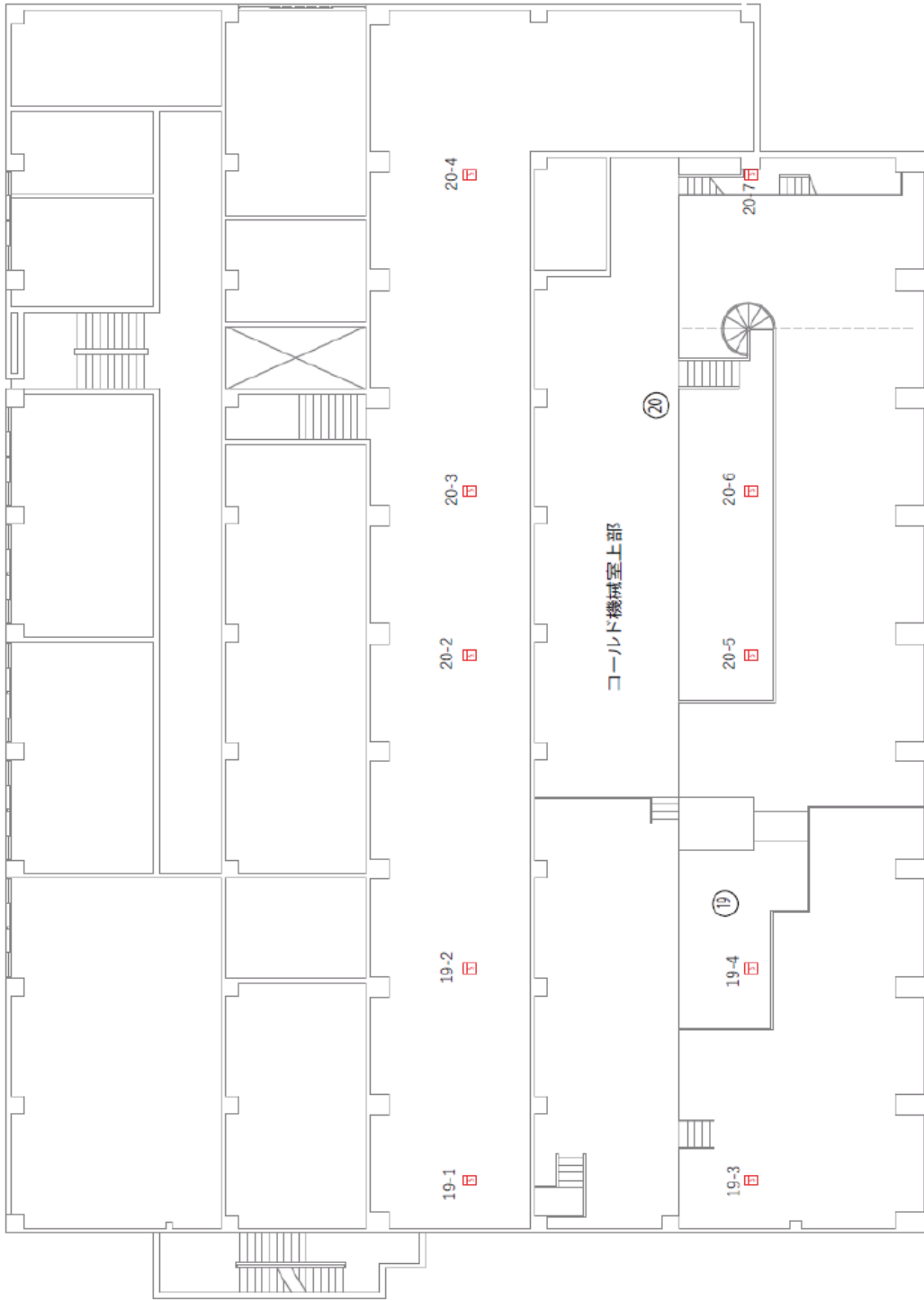
Fig.3.4.4 感知器及び発信機の配置図 (3階)
