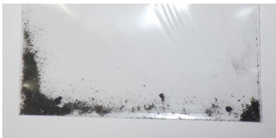
図 5-13 溶融槽上部270°側傾斜部の付着物を回収した試料
