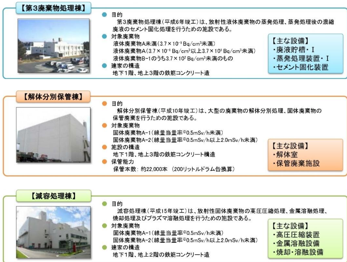
Fig. 2. 1. 1 第3廃棄物処理棟、解体分別保管棟及び減容処理棟の目的及び構造
