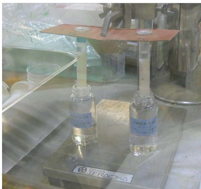
写真2 グローブボックス内での抽出クロマト法による Sr の分離 (左：Pb レジン、右：Sr レジン、樹脂量：2mL)
