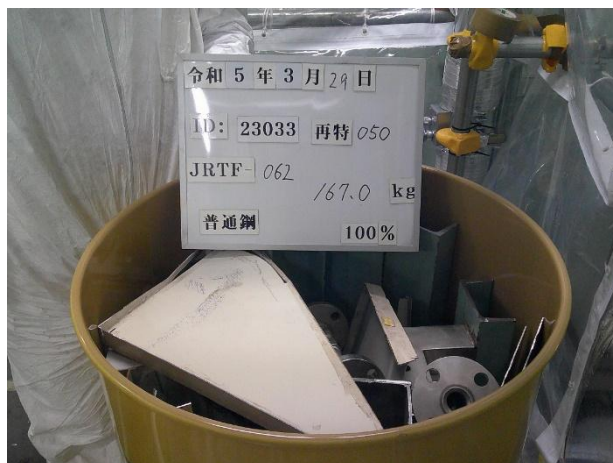
分別・仕分け作業がされた \beta ・ \gamma 廃棄物を封入したドラム缶
