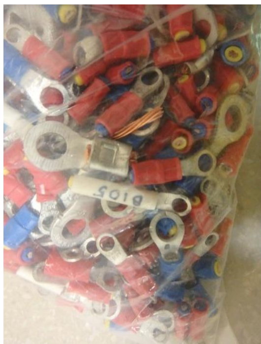
電気系統ケーブルのアルミ端子
