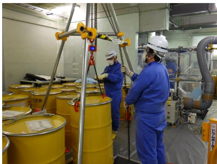
図 8 封入後ドラム缶の重量測定
