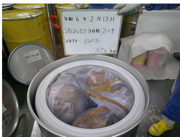
分別・仕分け作業がされた \alpha 廃棄物を封入したドラム缶
