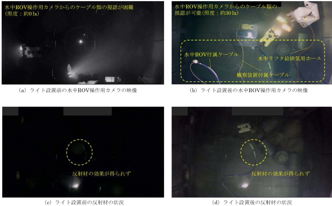
図 23 ライト設置前後における水中 ROV 操作用カメラの映像及び反射材の比較
