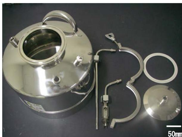
写真 16 ステンレス製容器の解体写真
