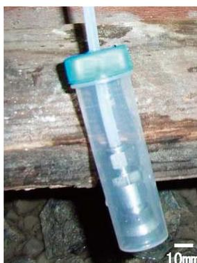
写真4 モニタリング装置に接続したクイックコネクツボディ（カバー内）
