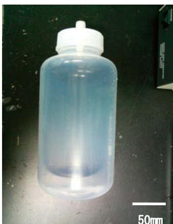
写真 18 テフロンボトルの蓋を装着した状態
