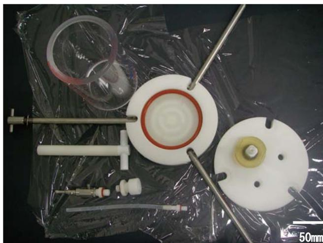
写真 15 ウルトラホルダーの解体写真
