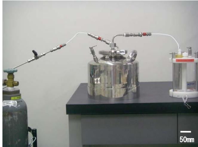
写真 10 実験室ろ過採水システムの構成
