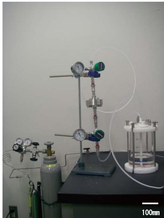
写真 3 原位置ろ過採水システム通水洗浄時の機器構成
