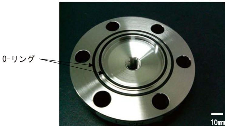
写真9 フィルターホルダーのO-リングの装着状態
