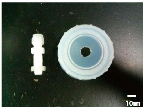
写真 17 バルクヘッドユニオンとテフロンボトルの蓋を開孔した状態
