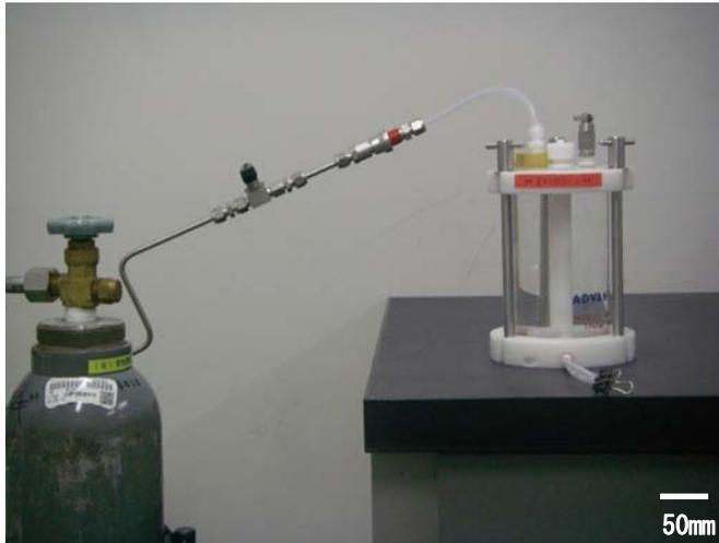
写真13 アルゴンガスボンベとウルトラホルダーを接続した状態
