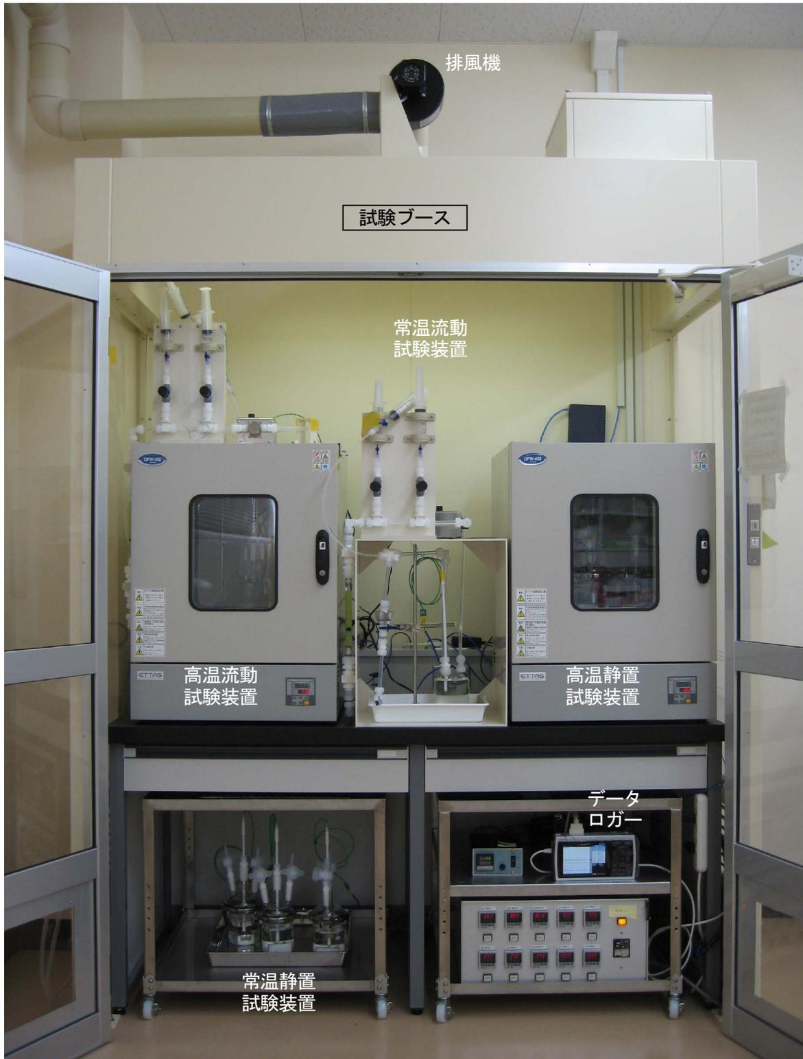
Fig. 2.9 試験ブース内の試験装置
