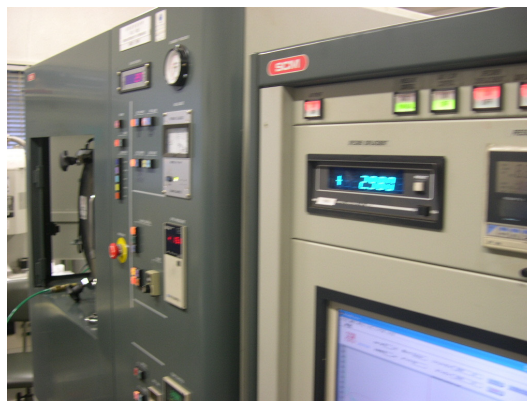
図 2 放電プラズマ焼結装置 (SPS装置) の外観写真
