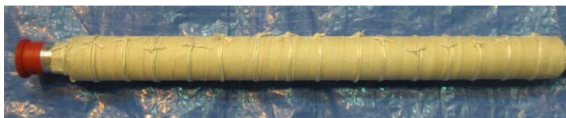
写真 2 絶縁テープ処理後の BF 3 比例計数管
