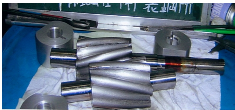
油ポンプ分解点検
