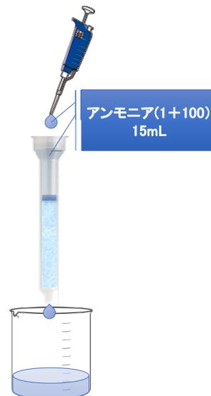
Fig.3.2(46)  $^{63}\text{Ni}$  の分析作業手順
