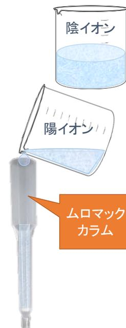
Fig.3.2(22)  $^{63}\text{Ni}$  の分析作業手順
