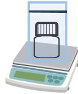
(10) 小分け容器をもとのビニール袋に入れ、重量測定し、「分析管理シート」【項目②】に記入する。この時、ポリ袋の外側はコールドとなるように扱う。ポリ袋の口を閉じ、重量測定して、燃焼ポートに移した瓦礫試料重量を求め、「分析管理シート」【項目③】に記入する。
