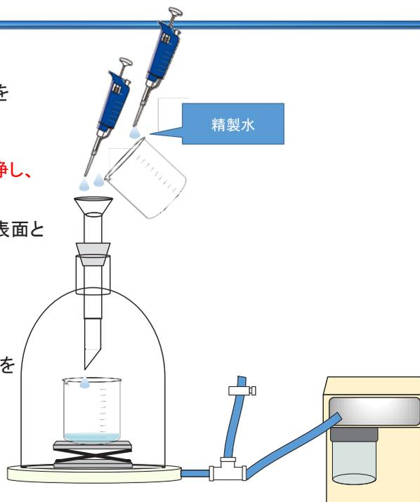
Fig.3.3(58)  $^{79}\text{Se}$  の分析作業手順
