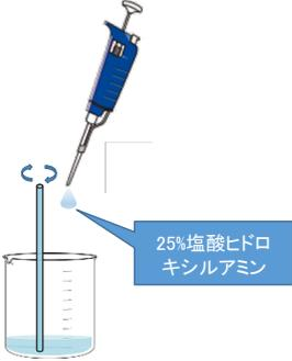
Fig.3.3(50)  $^{79}\text{Se}$  の分析作業手順
