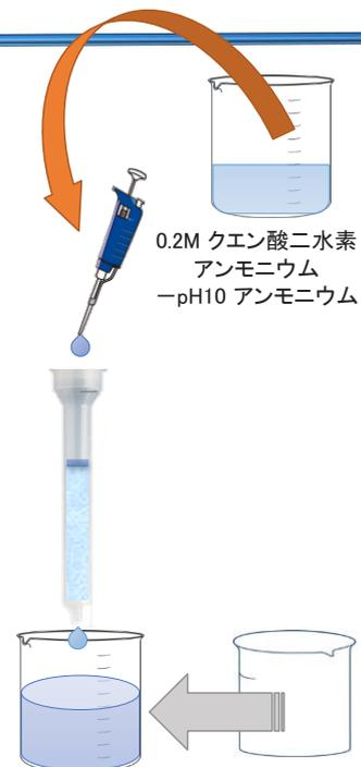
Fig.3.2(50)  $^{63}\text{Ni}$  の分析作業手順
