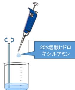
Fig.3.3(16)  $^{79}\text{Se}$  の分析作業手順
