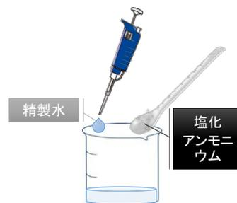
Fig.3.2(32)  $^{63}\text{Ni}$  の分析作業手順
