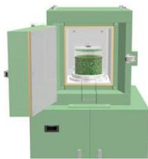
図: 試料搬入口を開放した状態の Ge半導体検出器
