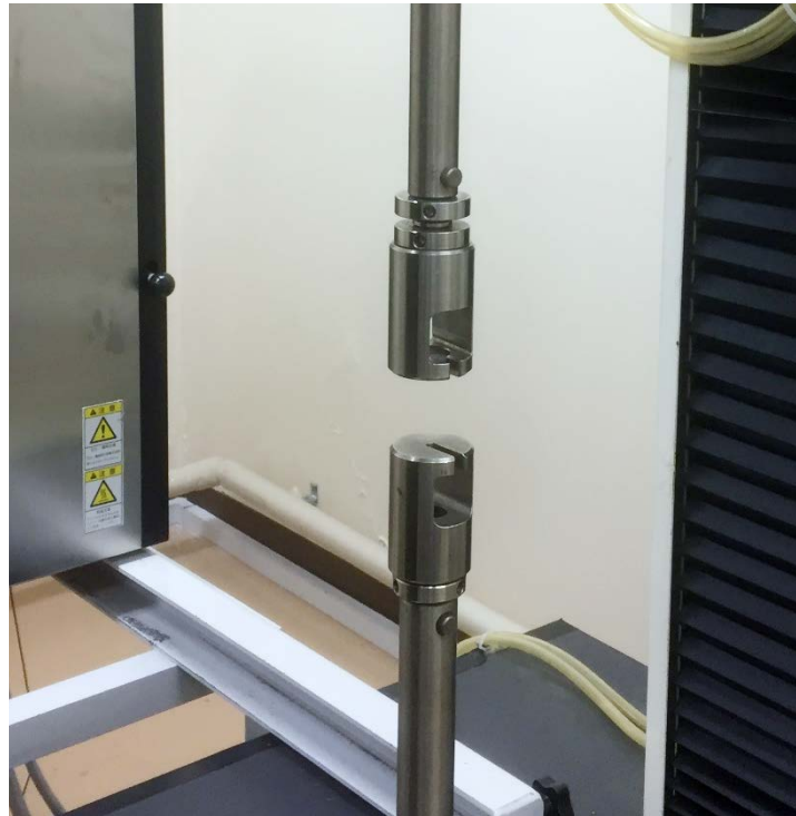
図 4.15 丸棒引張試験片対応型の試験治具
