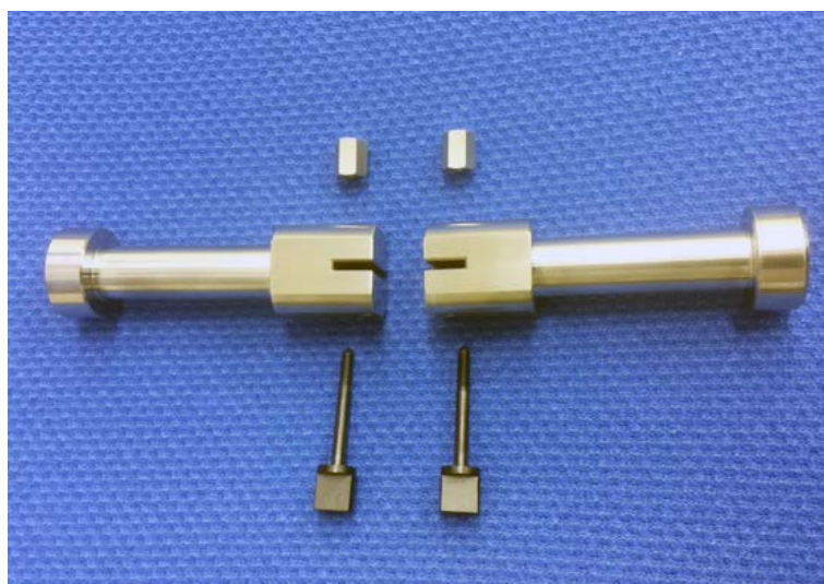
図 4.18 小型引試験片対応型の試験治具
