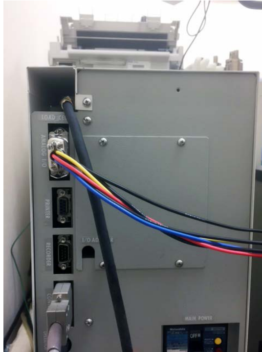
図 4.16 荷重（応力）データ外部出力コネクタ部（引張試験装置データ収集制御ユニット背面）
