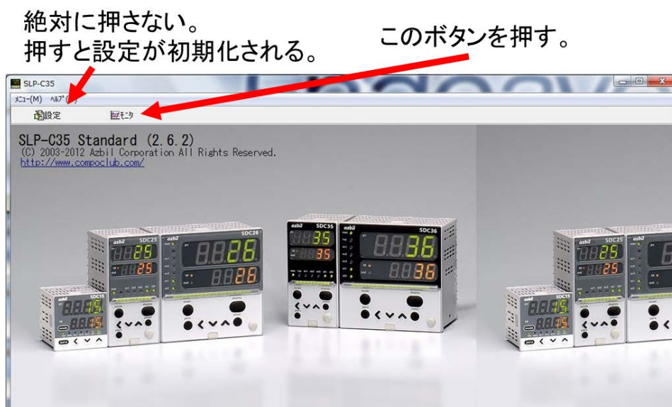
図 4.36 水蒸気発生供給装置の設定画面 (1)
