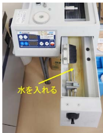
図 4.19 切断装置への水の供給
