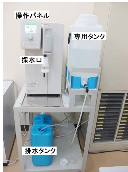
図 3.14 超純水製造装置の外観写真
