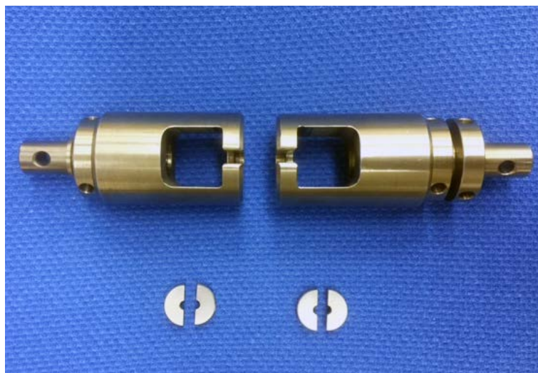
図 4.17 丸棒引張試験片対応型の試験治具
