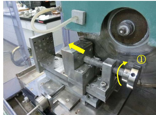
図 2.2-1 固定器具全景 ①のレバーを回転させて試料の幅に合わせる。
