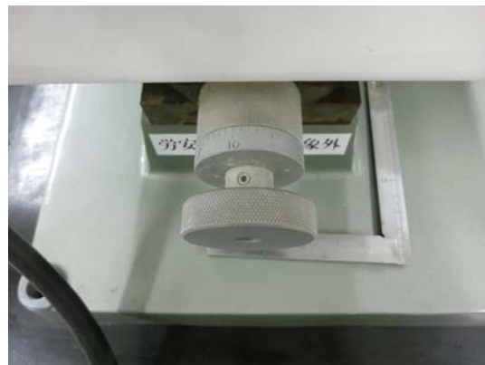
図 4.4 厚さ調整用の側面ダイヤル
