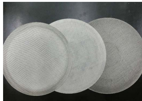
図 5.10 研磨クロス MOL 左から 3 μm、1 μm、0.25 μm
