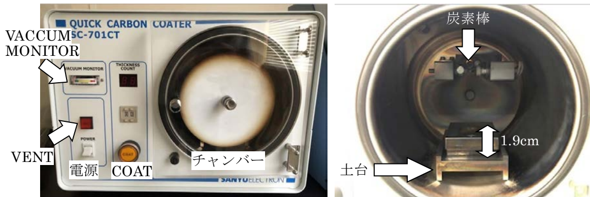
図 5.1 炭素蒸着装置（左）全体（右）チャンバー内の写真
