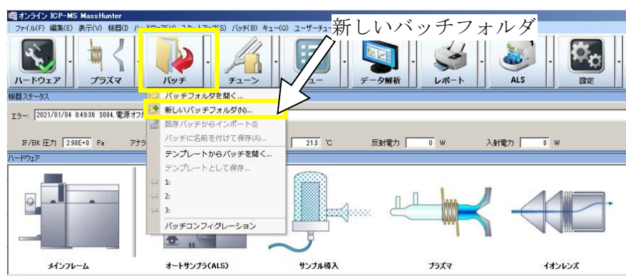
図 6.8 バッチフォルダを作成する操作画面
