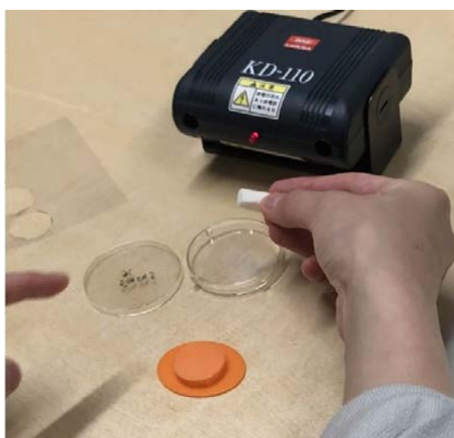
図 3.2 静電気除去装置とスポンジを用いた試料の貼付け
