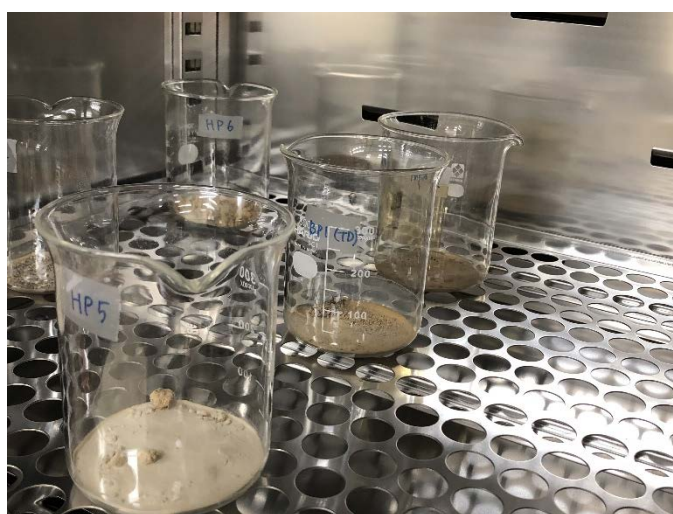
図 2.3 恒温器を用いた試料の乾燥
