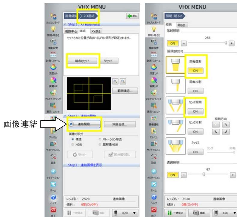
図 4.2 画像撮影の操作画面（左）画像連結、（右）照明・明るさの調整
