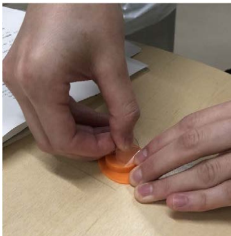
図 3.1 超透明両面接着シートのマウント成形プラカップ底面への貼付け
