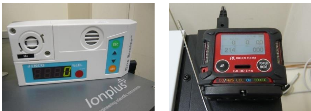
図 2.6.3 ガス警報器（左 H 2 濃度計：右 マルチガスモニター）
