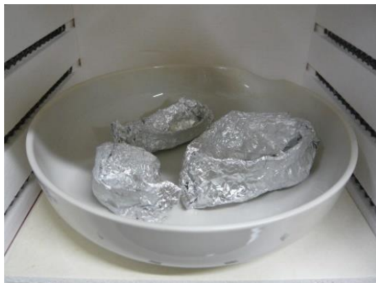
図 2.3.6 電気炉 (500℃) による銀ポートの加熱処理
