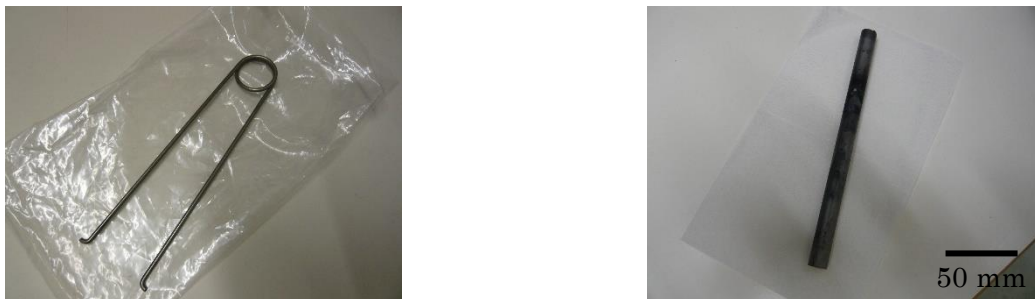
図 2.5.6 アッシュクルーシブルの取り出し （左 専用トング：右 アッシュクルーシブル）
