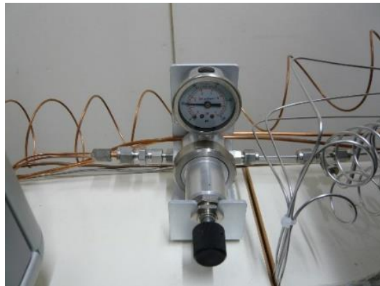
図 2.6.10 ガス流量の確認と調整 (上 ソフトウェア画面上にあるガス流量の確認画面 : 下 He ガスの流量調整用バルブ、TC-EA 本体右側に設置)
