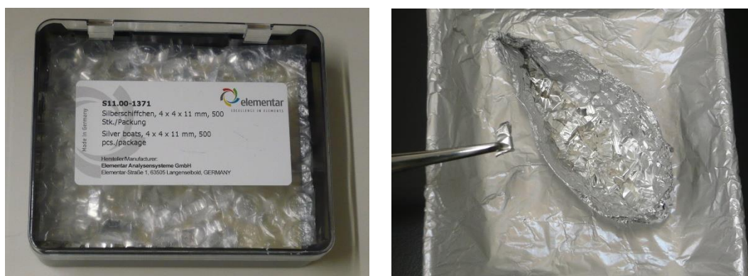
図 2.3.5 銀ボートの取り出し (左 銀ボート : 右 銀ボートを入れたアルミホイル)
