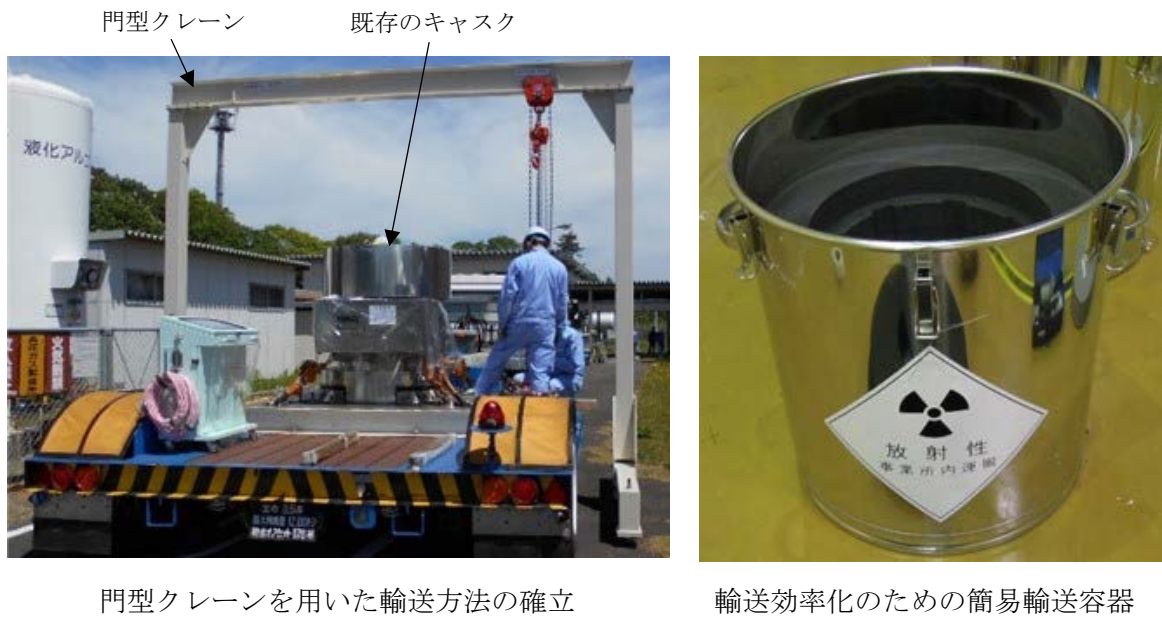
Fig. 2-4 貯蔵容器の輸送に係る安全な作業方法の確立と輸送効率の改善
