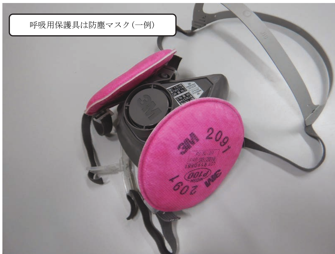
Fig. 6 作業装備（作業者のアスベストばく露防止措置）
