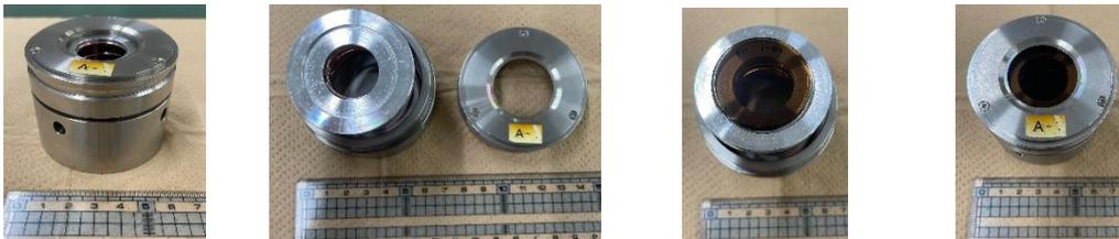
試料ホルダー 試料ホルダー本体(左)と蓋(右) ビードを設置 試料ホルダーに蓋設置
