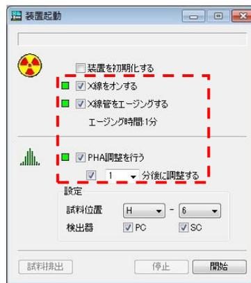
図 3.3.7 装置の起動および PHA 調整の基準
