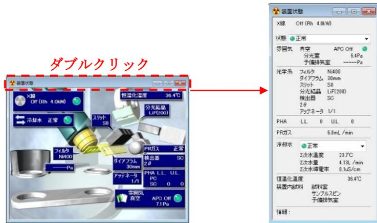
図 3.3.3 装置状態の確認
