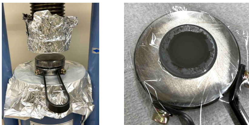
図 3.3.9 圧力開放後の状態（左写真）及び加圧成型した粉末プレス試料（右写真）
