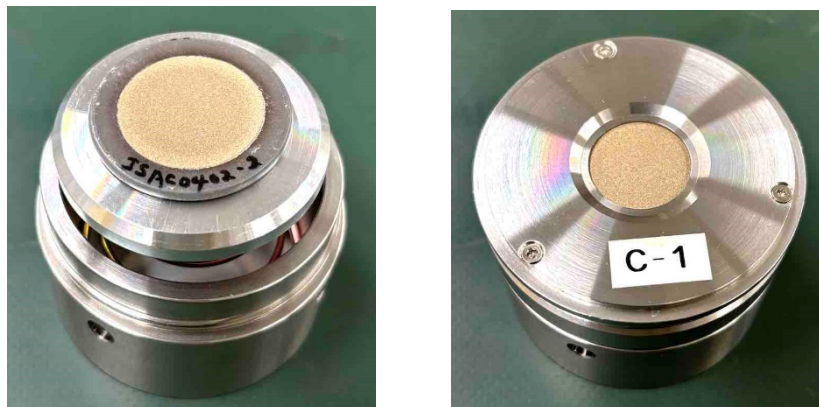
図 3.4.2 サンプルホルダーへの粉末プレス試料の設置
