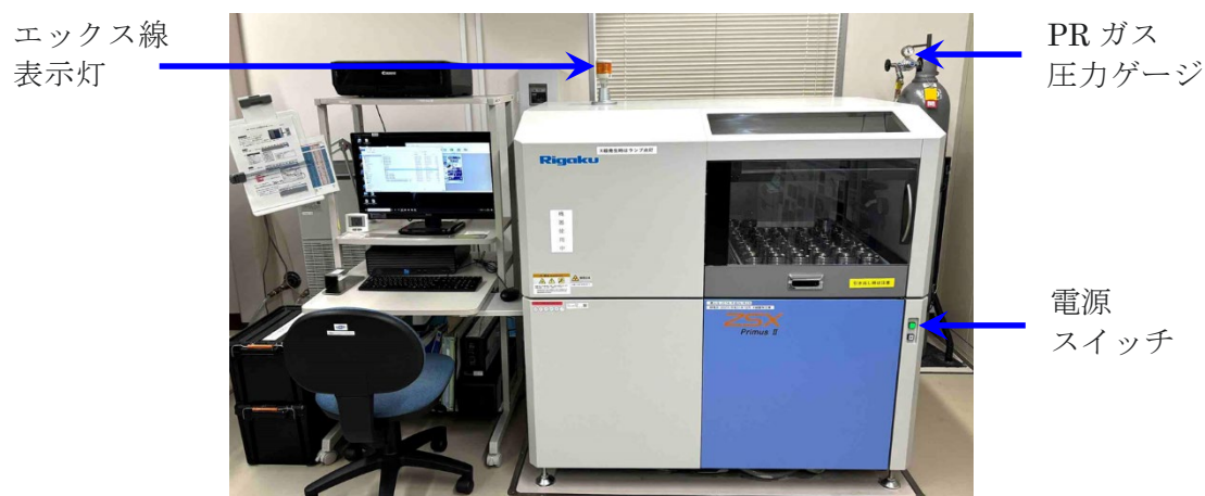
図 3.4.4 WDXRF 装置の電源等位置
