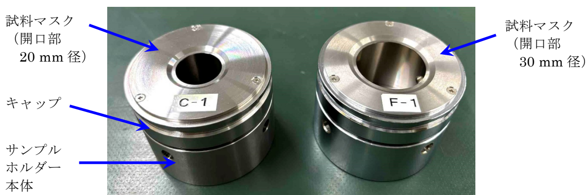
図 3.4.1 サンプルホルダー（開口部 20 mm 径（左写真）及び 30 mm 径（右写真））
