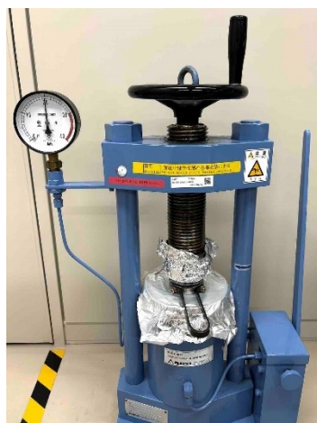
図 3.3.8 手動プレス機による試料の加圧成型（20 MPa まで加圧した状態）
