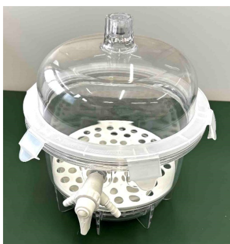
図 3.3.1-2 試料の保管用の真空デシケーター（左写真）及びオートドライデシケーター（右写真）
