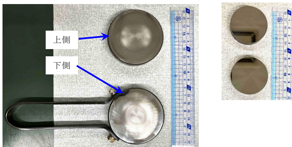
図 3.3.2 粉末ペレット試料の作製に使用する試料成形用ダイス（左写真） 及び少量試料用ダイペレット（右写真）
