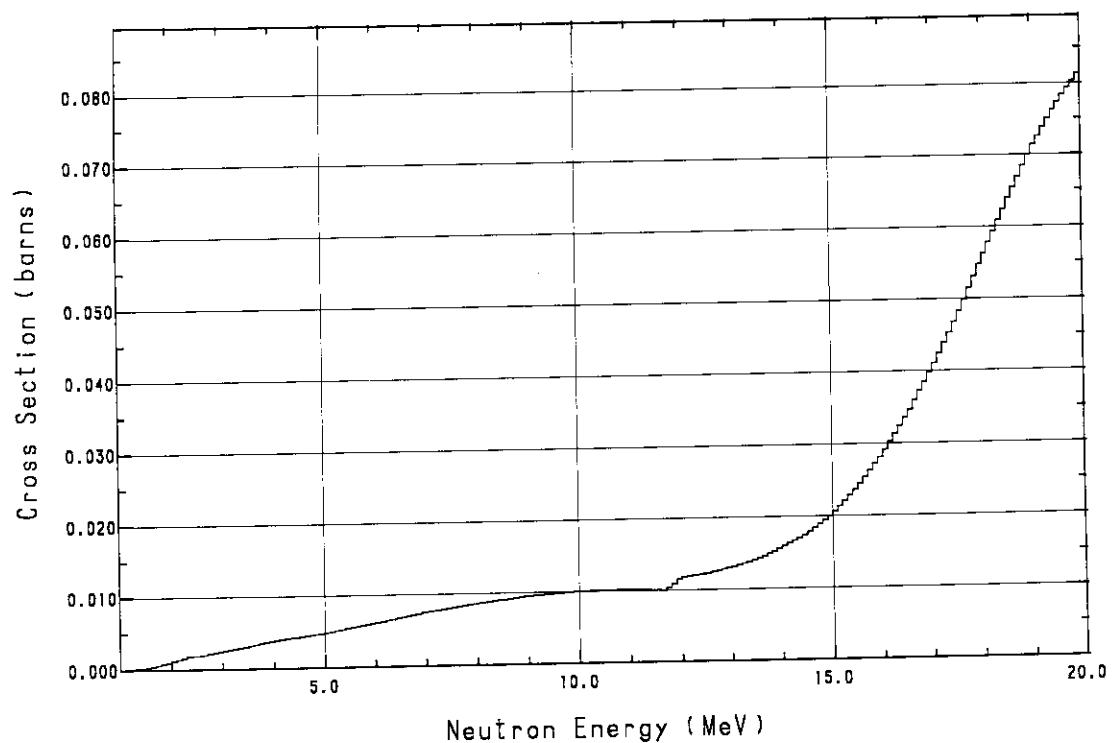
Fig. A.16  $\text{Ti}(n, x)^{47}\text{Sc}$  cross section
