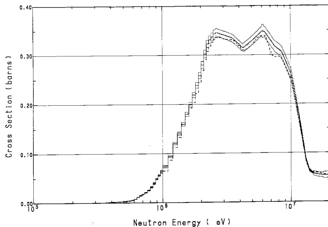
Fig. A.45  $^{115}\text{In}(n, n')$   $^{115\text{m}}\text{In}$  cross section
