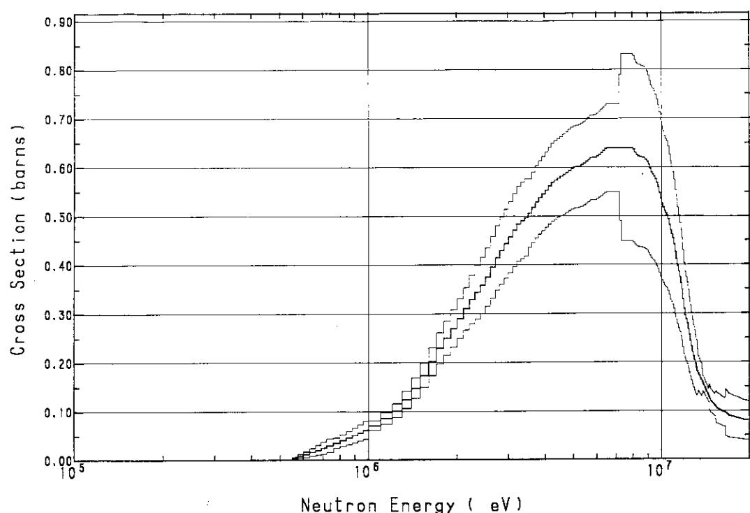
Fig. A.53  $^{199}\text{Hg}(n, n')^{199\text{m}}\text{Hg}$  cross section
