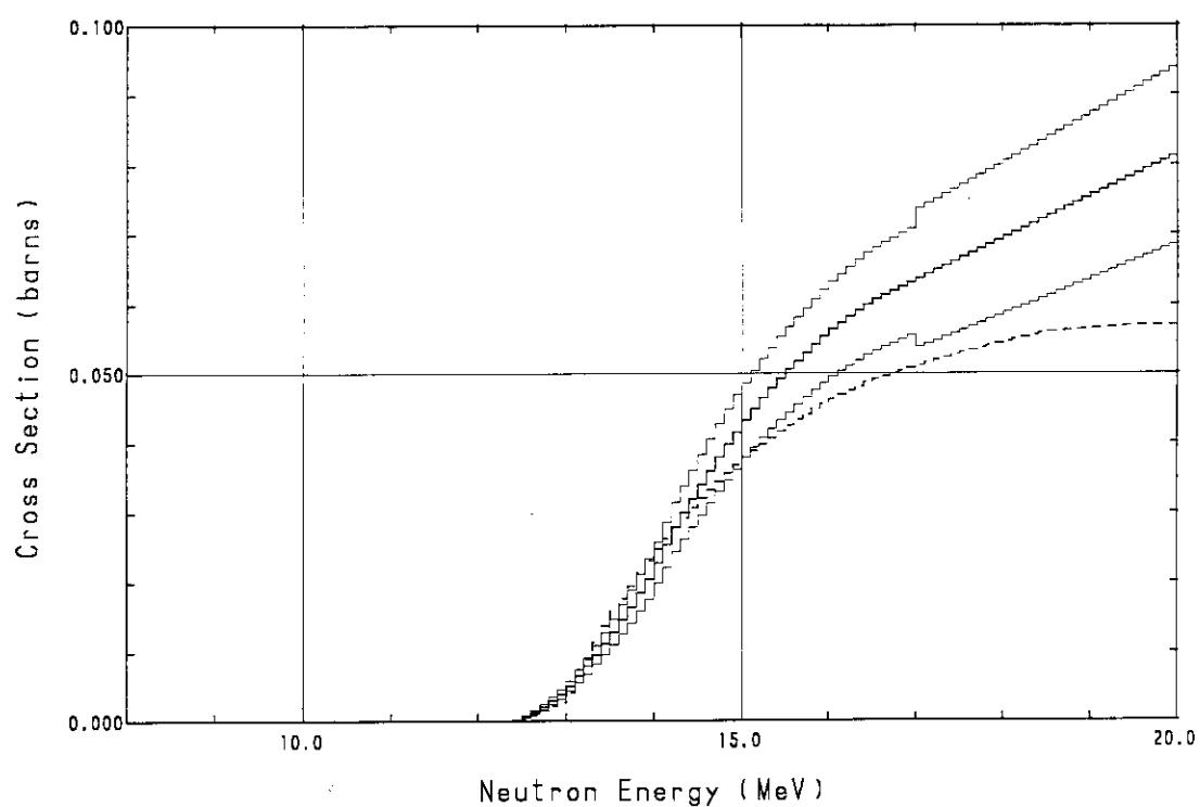
Fig. A.33  $^{58}\text{Ni}(n, 2n)^{57}\text{Ni}$  cross section
