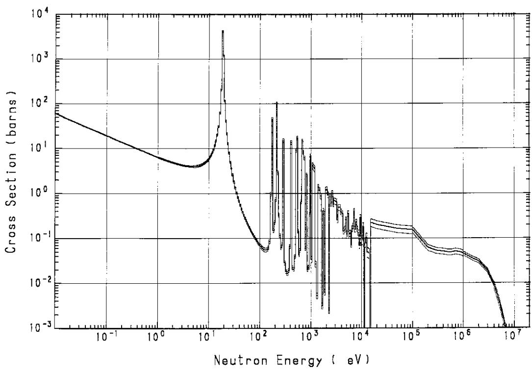
Fig. A.50  $^{186}\text{W}(\text{n}, \gamma)^{187}\text{W}$  cross section
