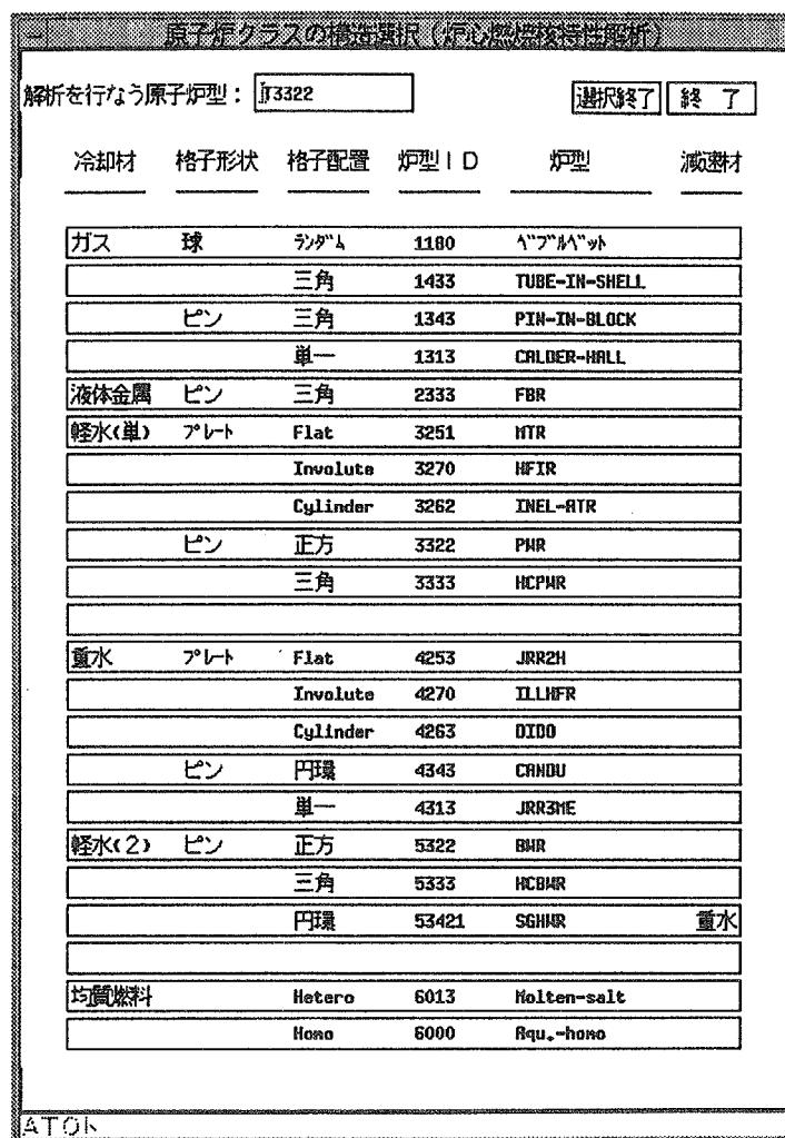
Fig.3.6-4 炉型選択画面
