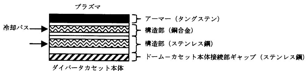
図4-4, ダイバータドーム部のモデル (全体厚さ=0.09m)
