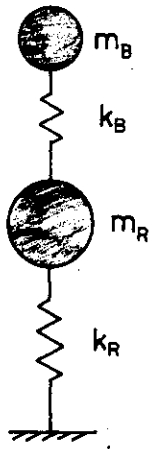
第3.12図 厚肉リングとベローズの2質点バネ・マスモデル
