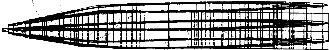
第 1.8 図 トロイダル磁場コイル詳細モデル 1 次固有振動モード，プロッタ出力図
