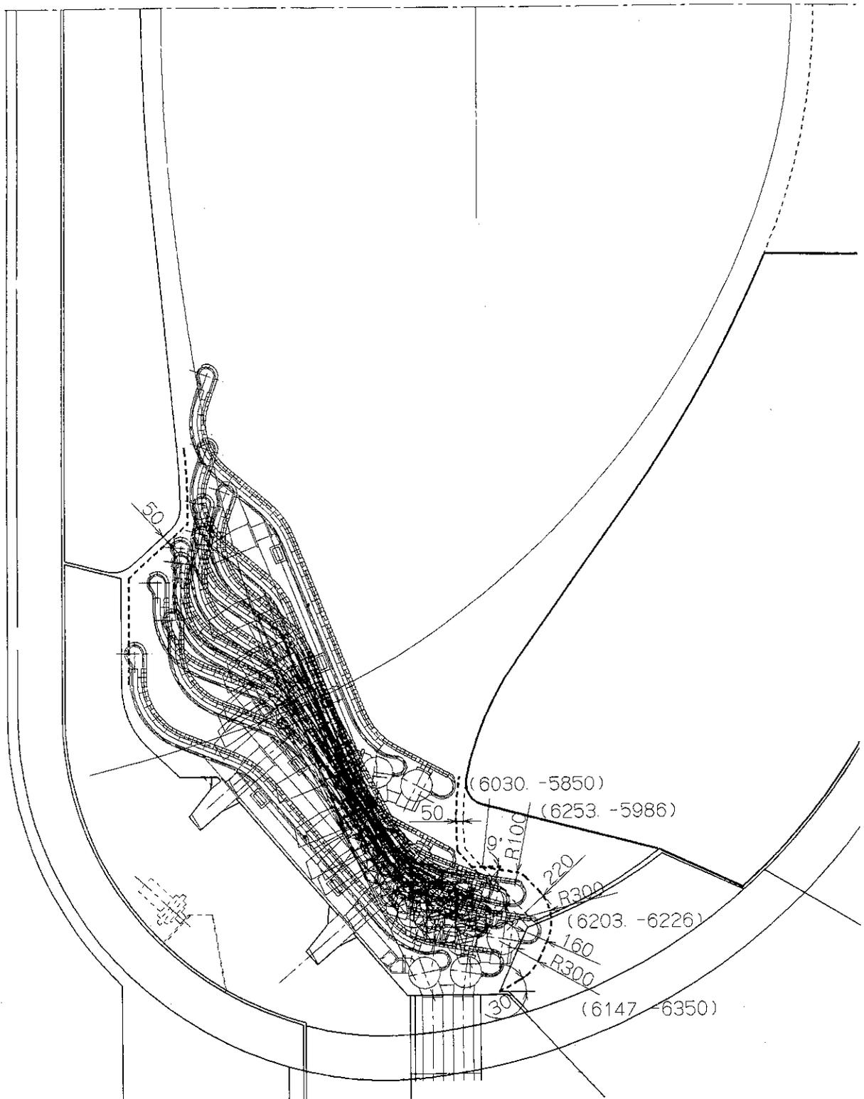
図 3. 2. 3 ダイバータ板の法線引抜後の搬送経路
