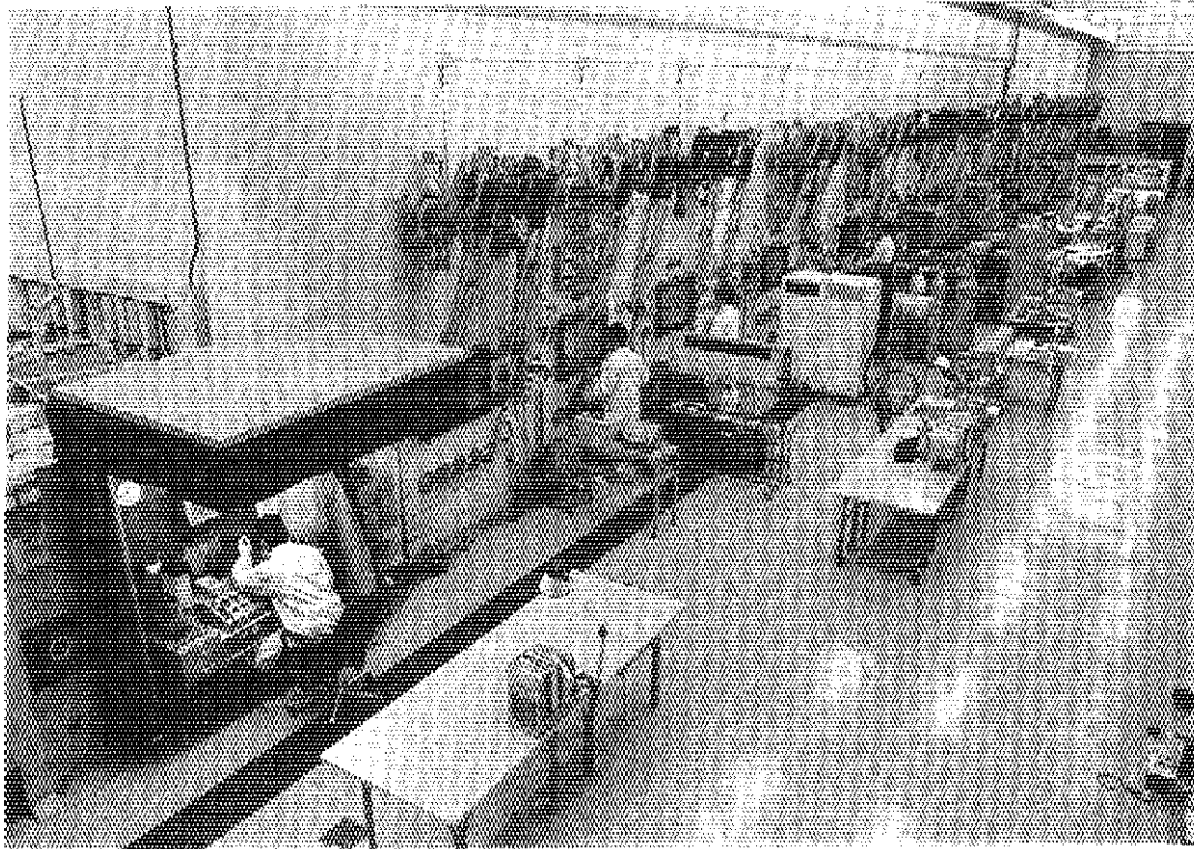
第3.2図 コンクリートセル操作室
