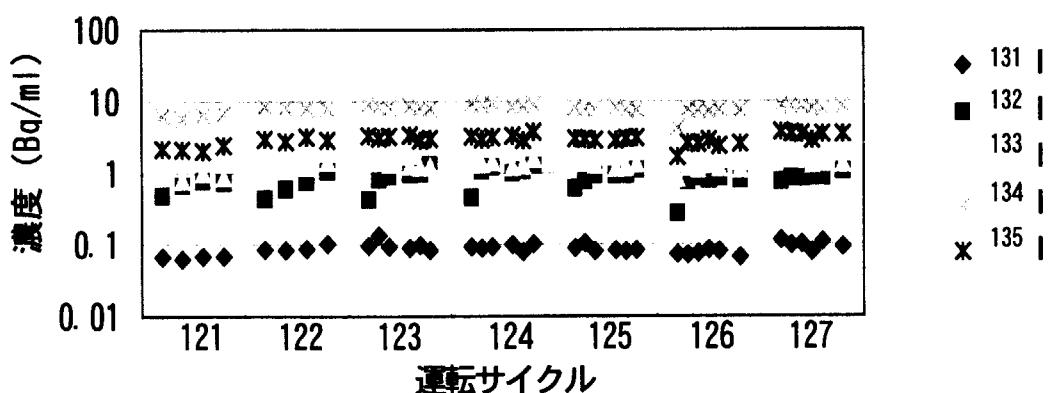
図2.1.4 一次冷却水中の放射性核種濃度
