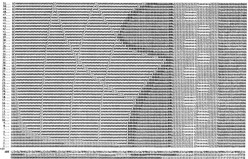
図 3-3 DOT3.5R-θ モデルメッシュ図 (CASTOR 断面)
