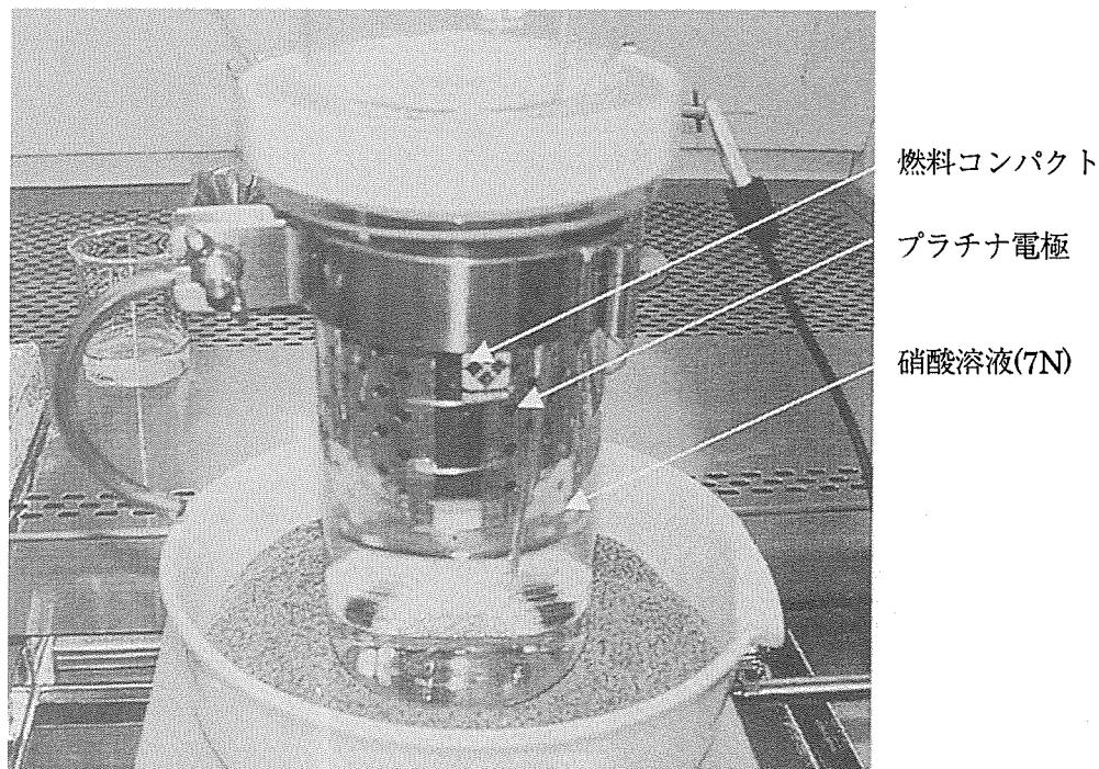
図 4.3.4 貫通破損率測定（電気解碎）のセル外モックアップ試験
