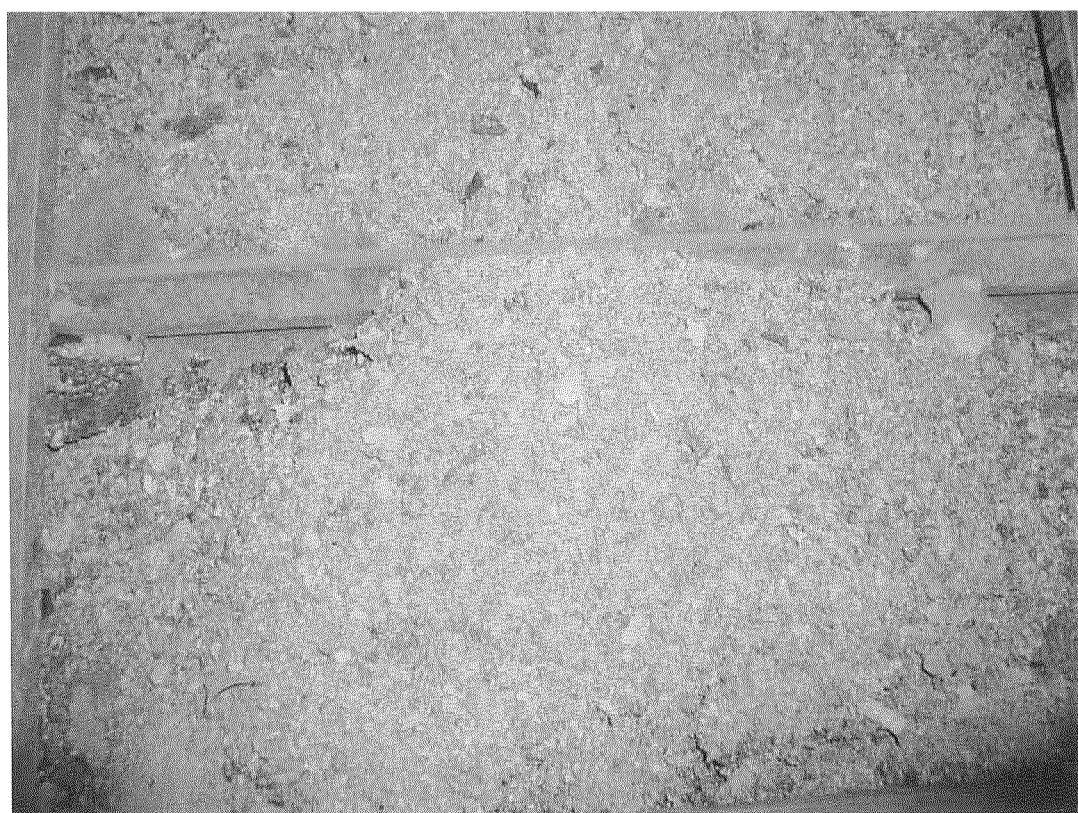
写真 2 一次灰溜室内の灰の堆積状況（11月20日焼却分）
