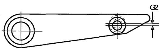
(2) アームの駆動軸取付穴と弁軸取付穴のずれ
