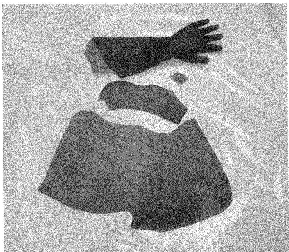
写真 1 グローブの破損状況
