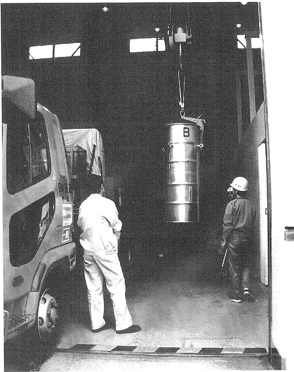
Fig. 15 樹脂筒輸送容器を機排棟天井クレーンで吊り上げ
