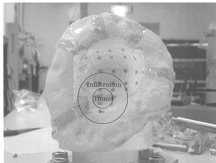
Fig.13 頭部モデルファントム（ヘルメット付）と測定結果の合成写真
