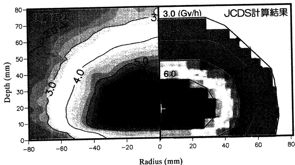
Fig.5.10 ENB モードでのファントム内  $\gamma$  線量 2 次元分布の比較
