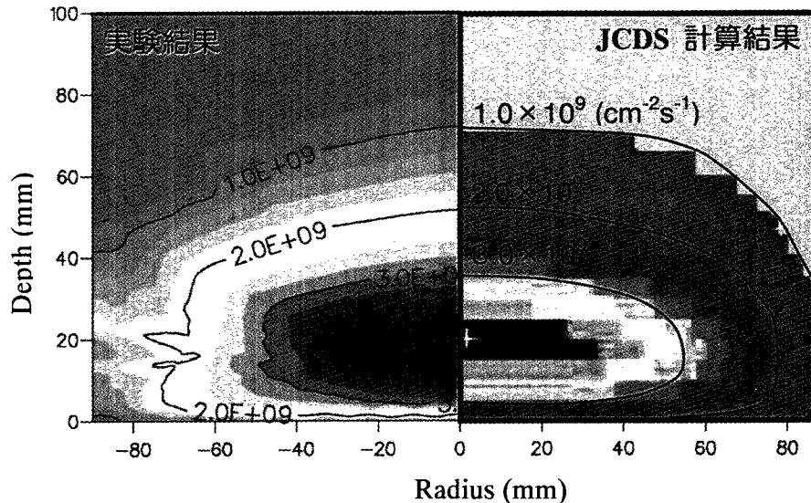
Fig.5.7 ENB モードでのファントム内熱中性子束 2 次元分布の比較
