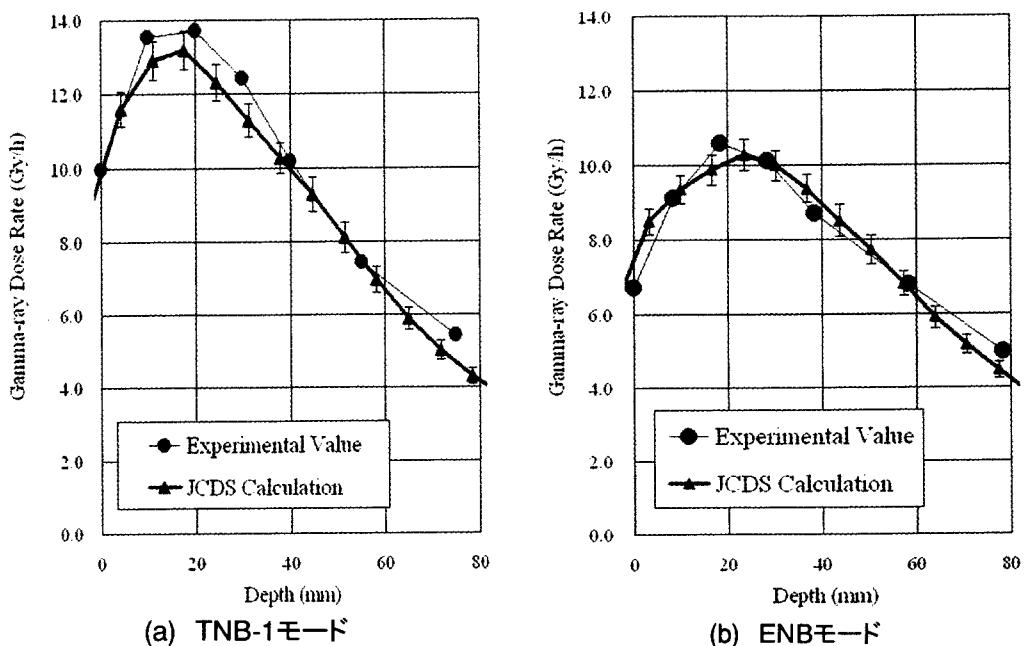
Fig.5.8 ファントム内ビーム中心軸上の  $\gamma$  線量分布の比較
