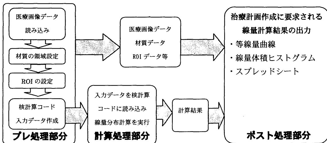
Fig.3.1 線量評価を実行する処理の流れ
