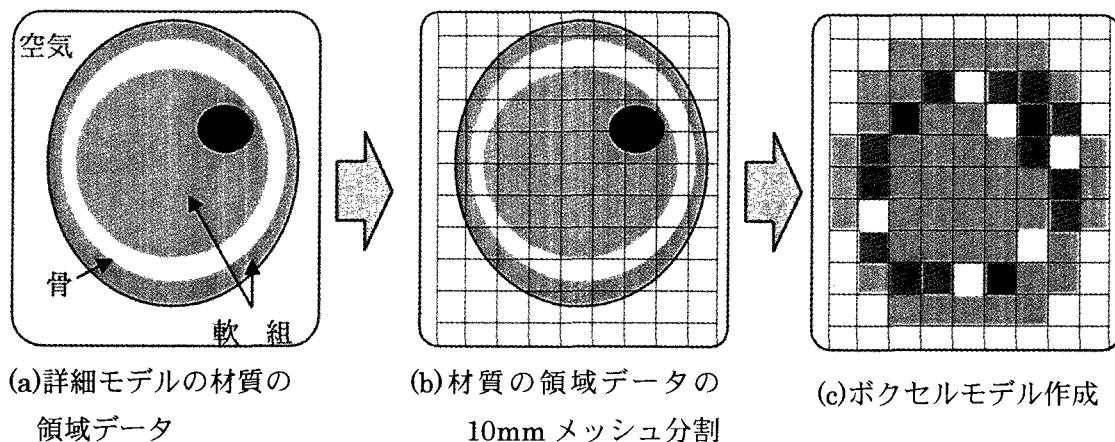
Fig.4.13 詳細頭部モデルからボクセルモデルの作成方法
