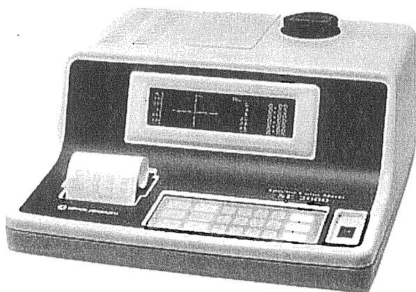
図1.4 分光式色差計（日本電色工業（株）製 SE-2000）
