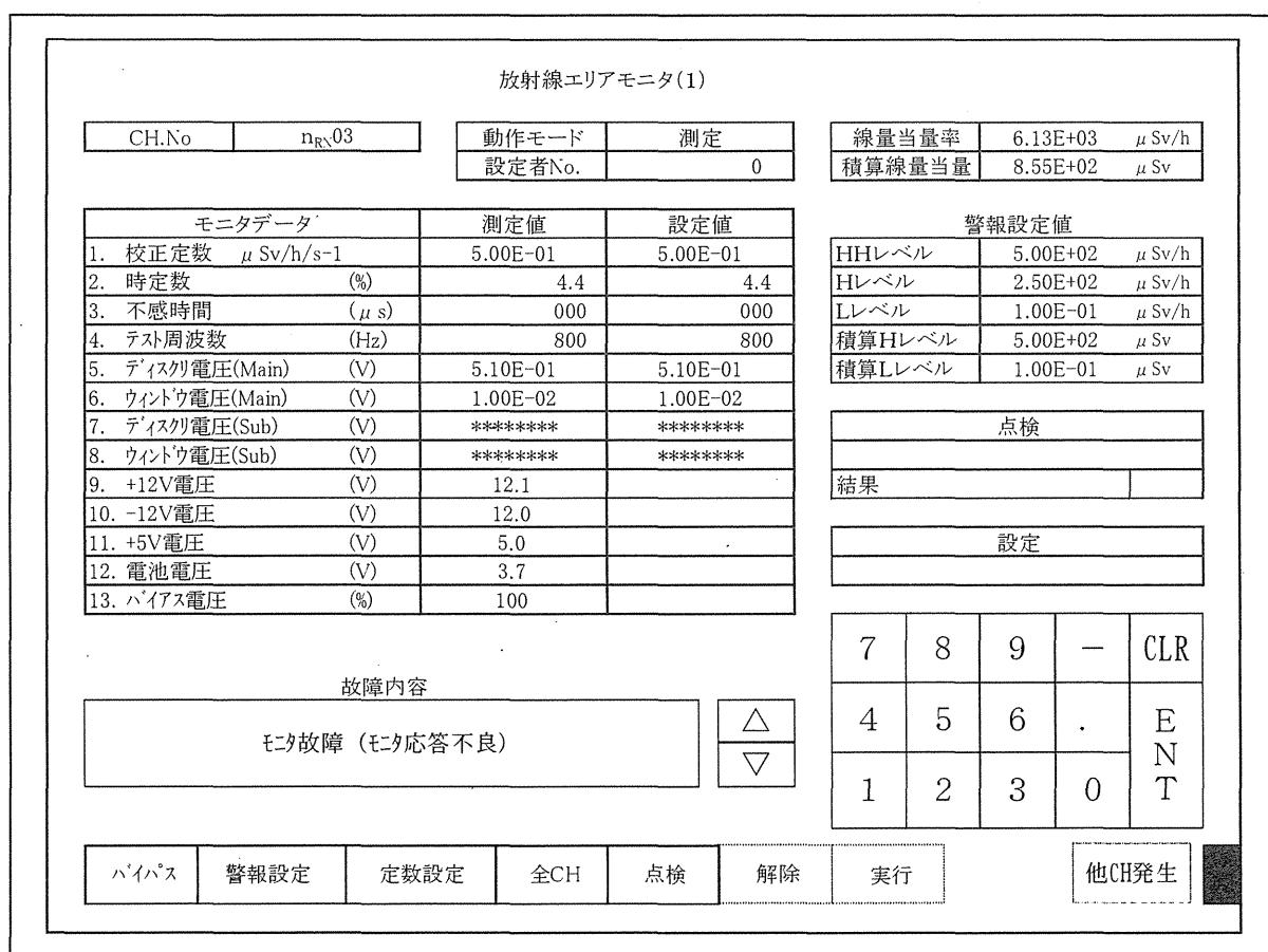
図 4.2.2-3 プログラマブル表示器個別系統画面
