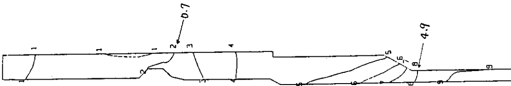
内圧(48kg/cm 2 ) \sigma_{\theta} : 円周方向応力分布 第4.19(n) 図 制御棒スキャンパイクの応力分布図
