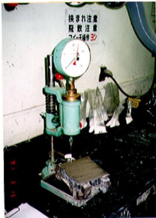
写真 1.1 凝結試験（プロクター貫入試験）
