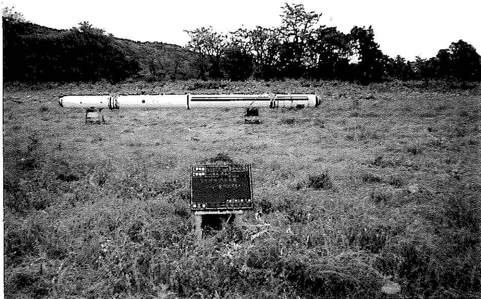
電磁法探査用バード
