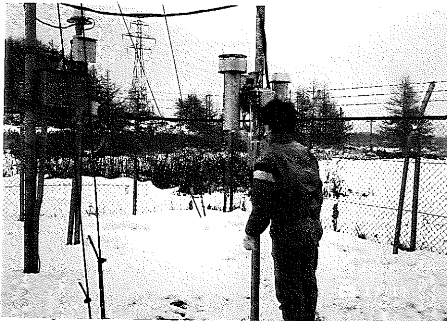
気温計・露点計点検
