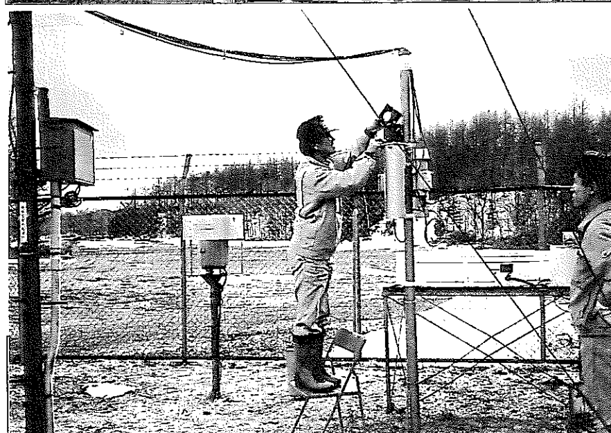
気温通風用 ファン交換
