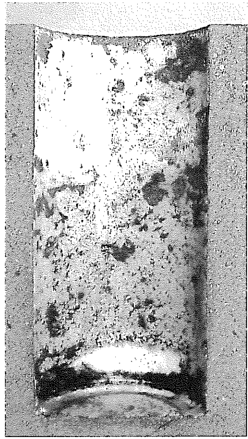
C-7 シリケート泥水 A・泥岩・浸透試験後切断面拡大
