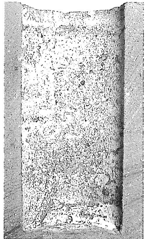
C-16 シリケート泥水 B・泥岩・回復試験後切断面拡大
