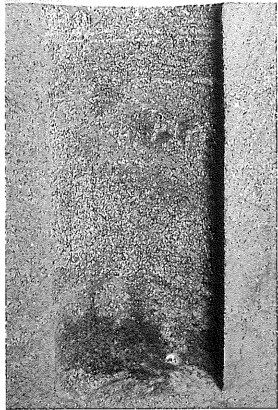
C-12 シリケート泥水 B・砂岩・回復試験後切断面拡大
