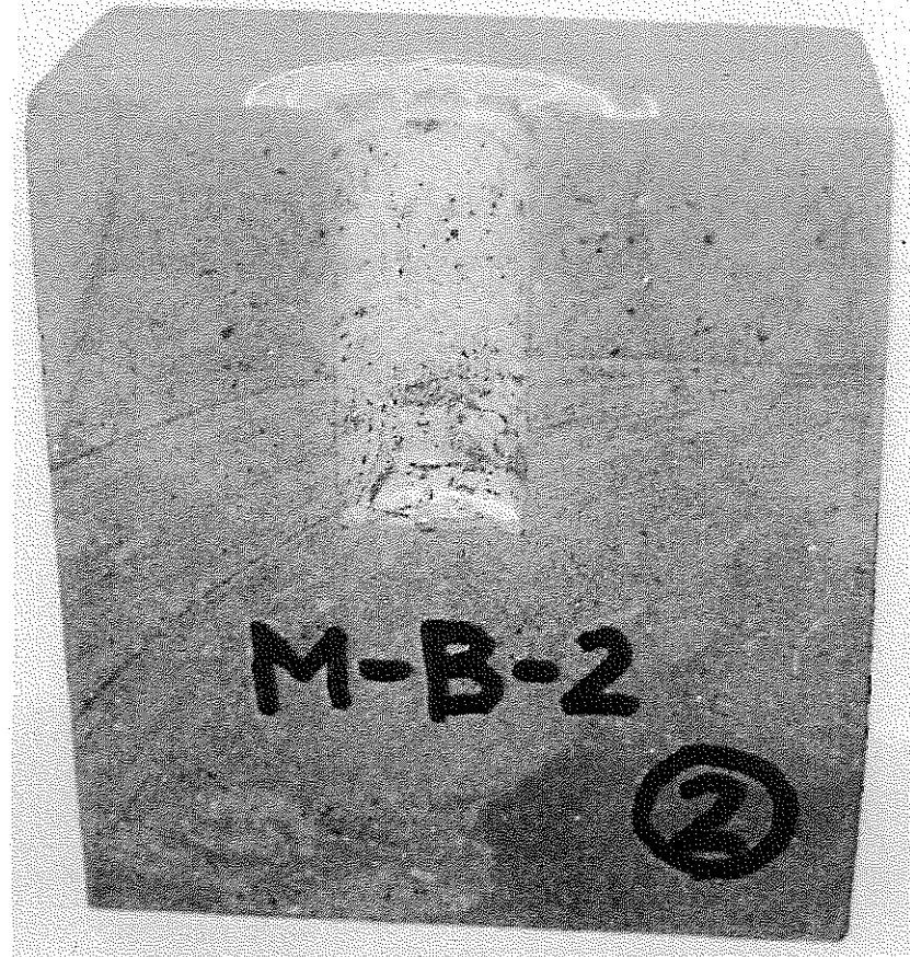
C-14 シリケート泥水 B 回復試験後切断面 (泥岩 M-B-2)
