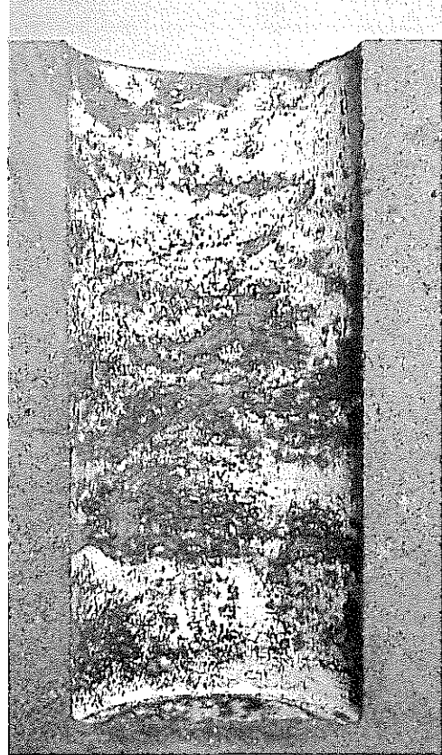
C-8 シリケート泥水 A・泥岩・回復試験後切断面拡大
