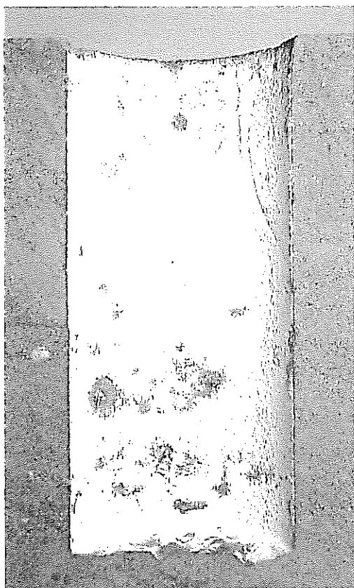
C-3 シリケート泥水 A・砂岩・浸透試験後切断面拡大
