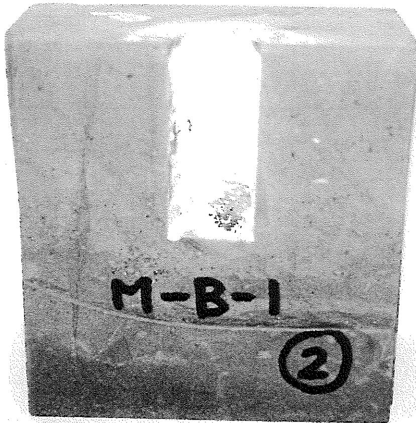
C-13 シリケート泥水 B 浸透試験後切断面 (泥岩 M-B-1)
