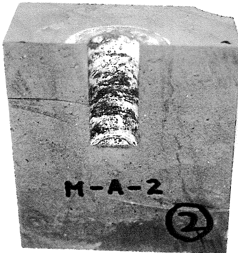
C-6 シリケート泥水 A 回復試験後切断面 (泥岩 M-A-2)
