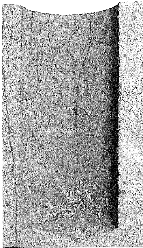
C-19 KCL-リグネート泥水・砂岩・浸透試験後切断面拡大
