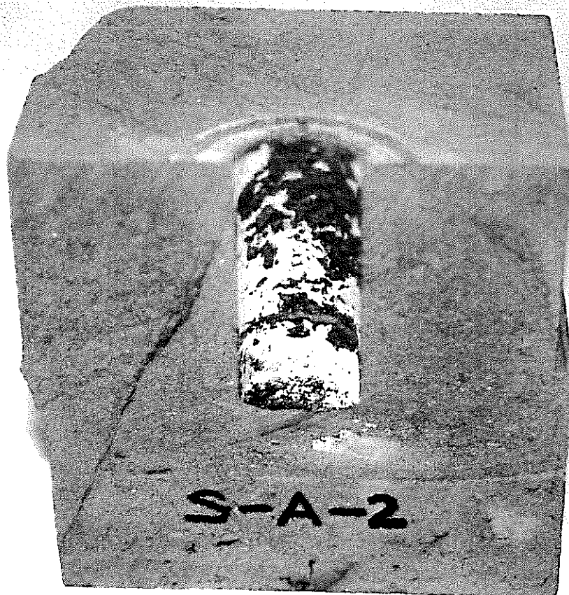
C-2 シリケート泥水 A 回復試験後切断面 (砂岩 S-A-2)
